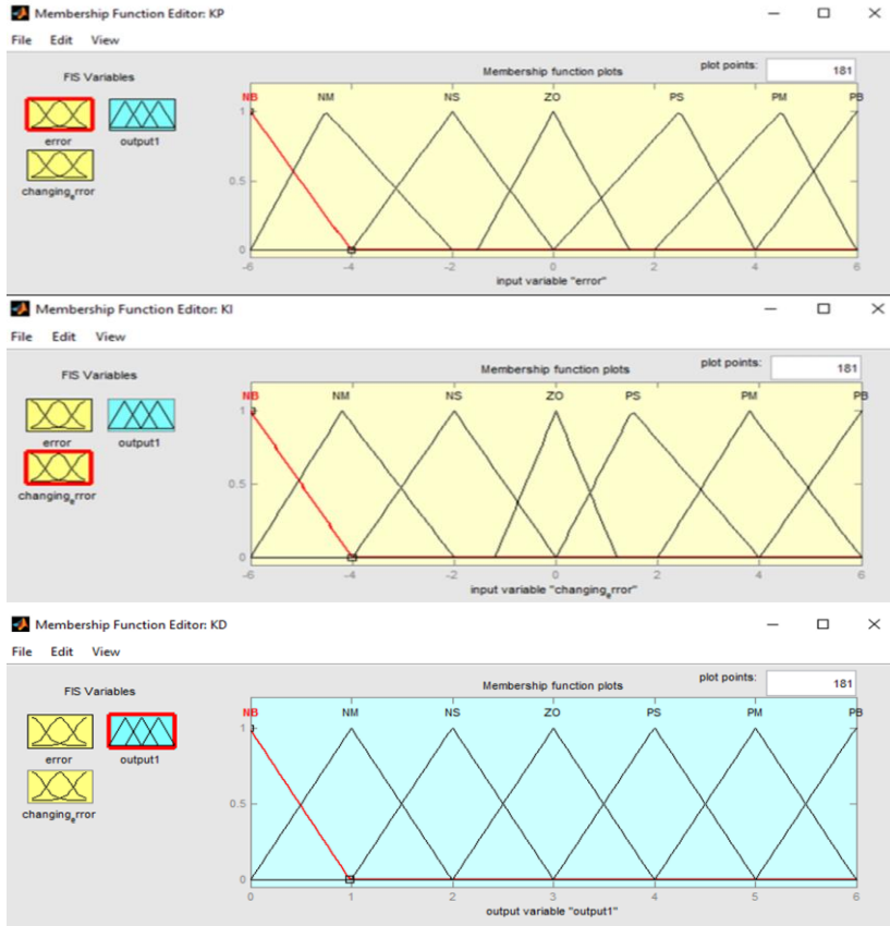
Рисунок 3. Функции принадлежности для переменных KP и KI, KD
