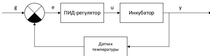
Рисунок 1. Схематическое проектирование процесса ПИД-регулирования
