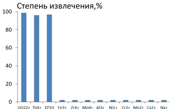
Рисунок 1. Экстракция U(VI), Th(IV), La(III), Nd(III) и Eu(III) 0,05 М раствором N-дифенилфосфорил-N'-n-октилмочевины в хлороформе из модельного азотнокислого раствора (2,5 М) в присутствии примесных элементов
