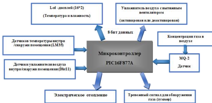
Рисунок 3. Блок-схема контроля температуры/загрязнения воздуха
