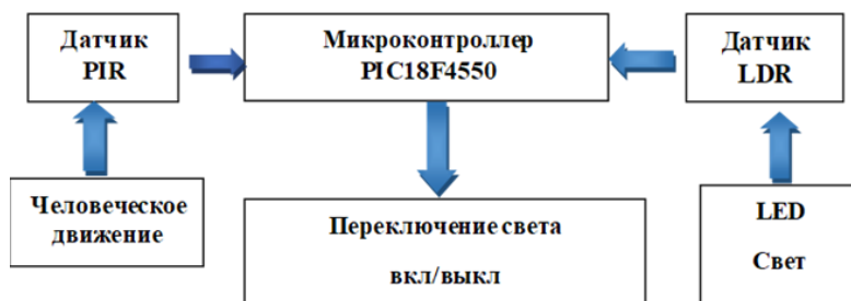
Рисунок 4. Блок-схема управления освещением
