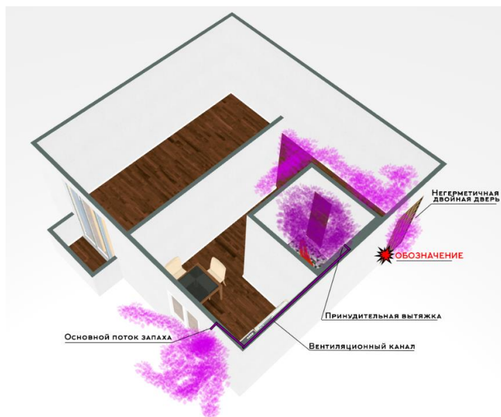
Рисунок 2. План квартиры и схемы выхода запаха
