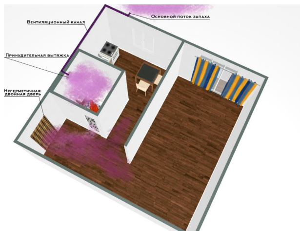
Рисунок 3. План квартиры и схемы выхода запаха
