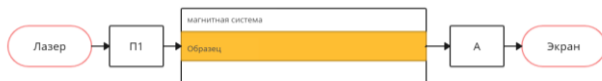
Рисунок 2. Схема установки для анализа магнитных систем на основе эффекта Фарадея: лазер, П1 – поляризатор, А – анализатор, экран, магнитная система – исследуемая магнитная система, образец – магнитооптическое вещество
