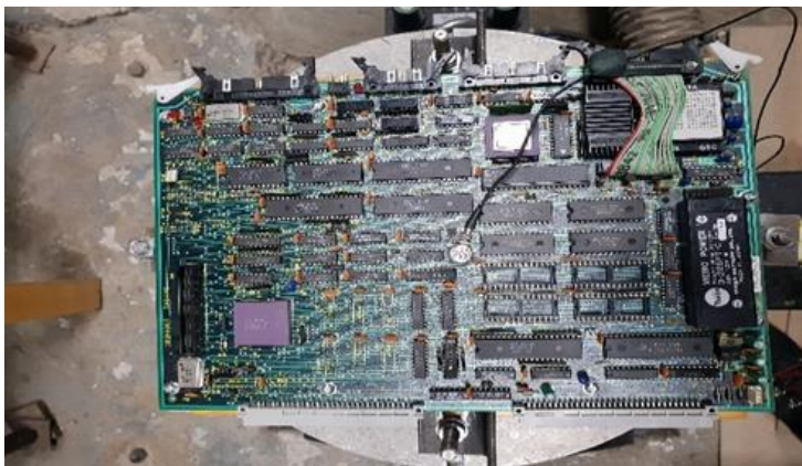
Рисунок 2. Плата, установленная на вибростенде
