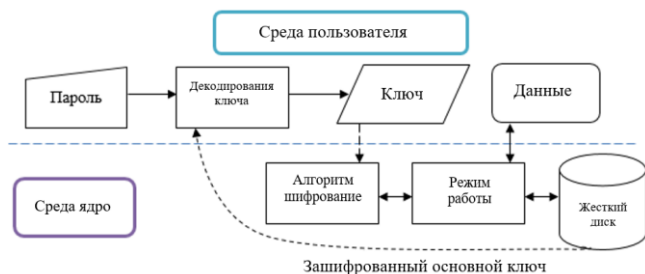
Рисунок 1. Изображение. Метод шифрования LUKS (Linux Unified Key Setup)
