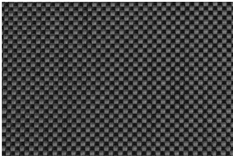
Рисунок 2. Углеродная ткань PLAIN 3K-1000–240
