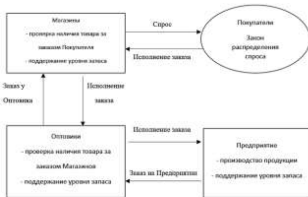
Рисунок 1. Схема имитационной модели управления запасами между элементами логистической системы
