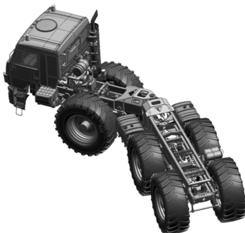
Рисунок 6. КАМАЗ 6х6 "Габарит" с сочлененной рамой
