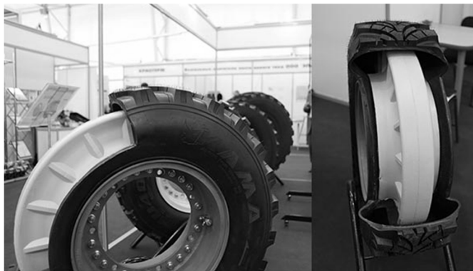
Рисунок 2. Боестойкое колесо «Кама»
