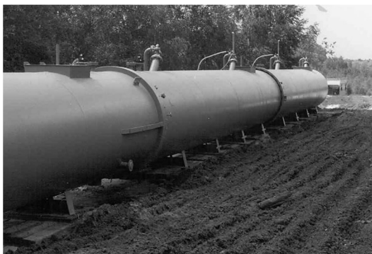
Рисунок 3. Общий вид лежащего реактора, собранного из 3 емкостей (обрабатываемая зона в реакторе, при диаметре 2 метра – 36 x 1,6 м (высота наполнения) «Korting»
