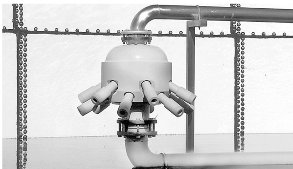
Рисунок 2. Эжектор «Korting», общий вид
