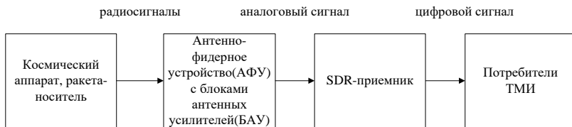
Рисунок 4. Схема процесса приема и сбора телеметрической информации с применением SDR-приемника
