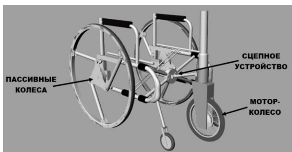
Рисунок 3. 3D модель ходовой части инвалидной коляски с мотор-колесом тянущего типа и пассивными амортизированными колесами
