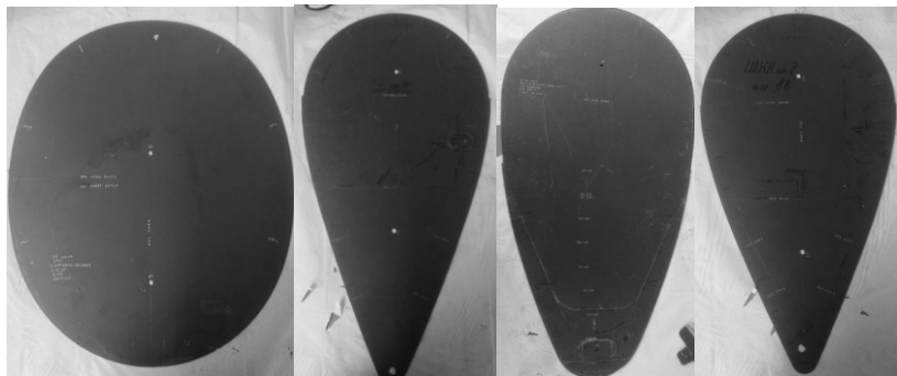
Рисунок 3. ШКК для килевой балки и обтекателя
