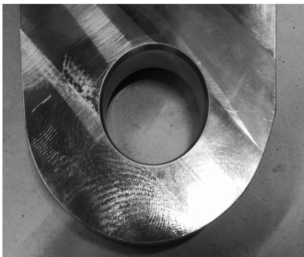
Рисунок 4. Получаемая шероховатость от Ra0.4 до Ra1.25
