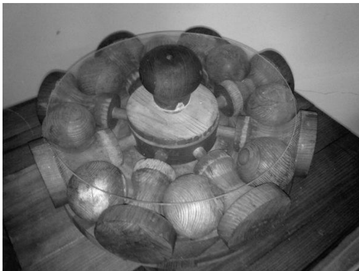
Рисунок 4. Макет шарикоподшипникового механизма, созданного по чертежу Леонардо
