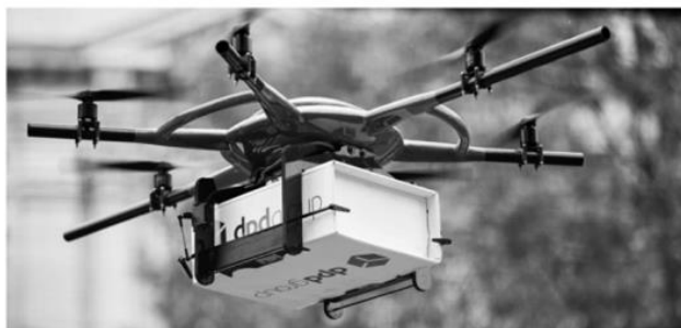
Рисунок 4. Общий вид нескольких ГКР: а) на коптере – 8 пропеллеров; б) коптер снабжен съёмными захватами
