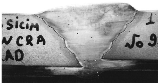
Рисунок 4. Макрошлиф с отпечатками (измерение твердости по Виккерсу HV 10)
