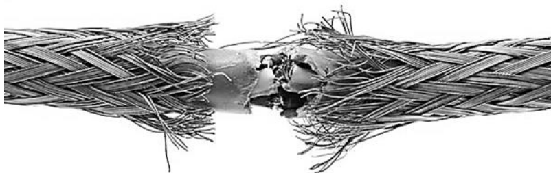
Рисунок 1. Поврежденная оболочка кабеля связи
