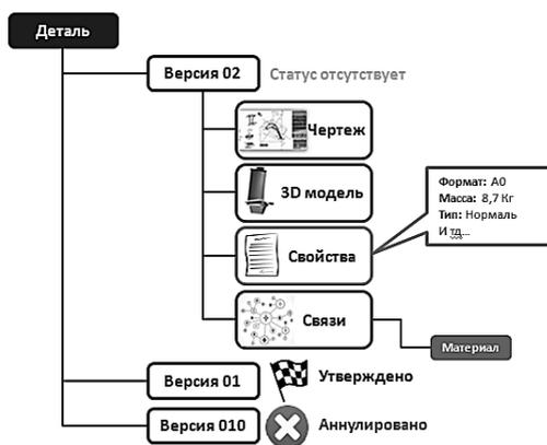
Рисунок 1. Архитектура хранения данных о детали в Teamcenter
