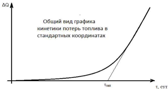
Рисунок 3. Общий вид графика кинетики потерь топлива при стандартных координатах «Изменение массы/время»
