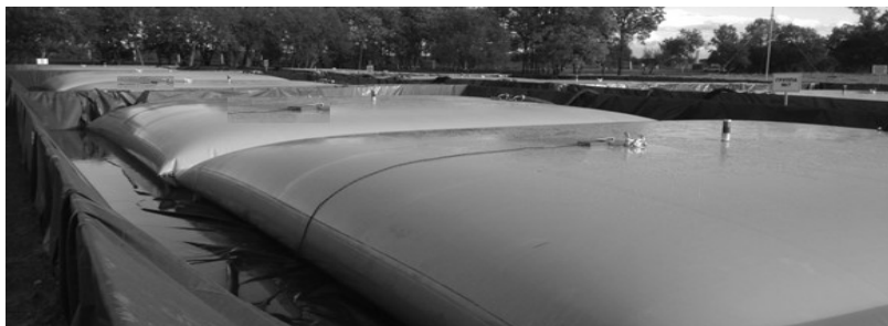
Рисунок 1. Общий вид эластичного резервуара для полевого склада горючего
