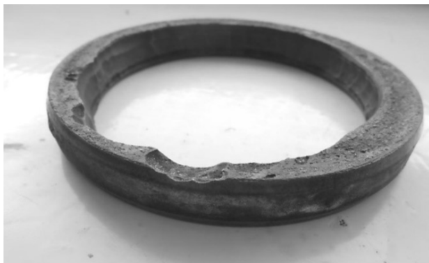
Рисунок 1. Коррозионное разрушение уплотнительного кольца
