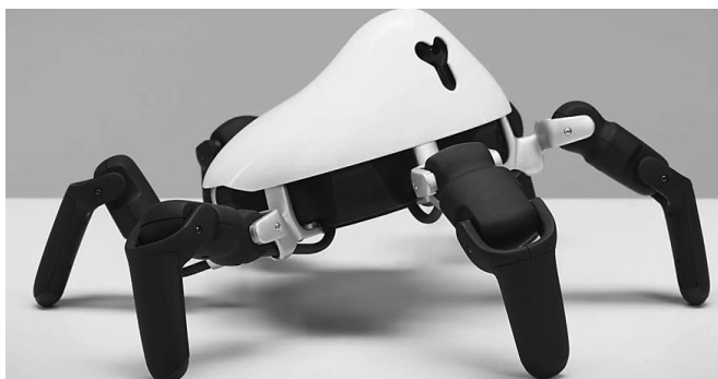
Рисунок 3. Шестиногий робот «Hexa» (Взято с сайта https://www.kickstarter.com )
