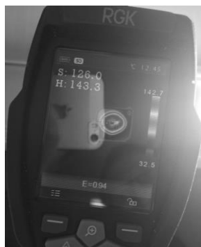
Рисунок 3. Распределение температуры корпуса в стационарном режиме (без линзы)
