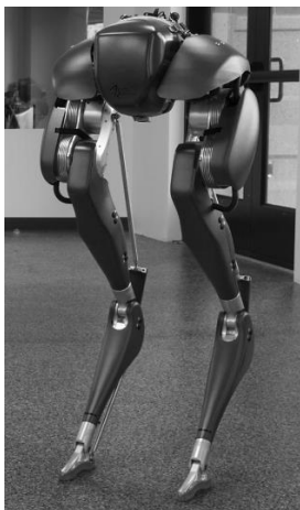
Рисунок 1. Двухногий шагающий робот «Cassie» (взято с сайта http://www.agilityrobotics.com )
