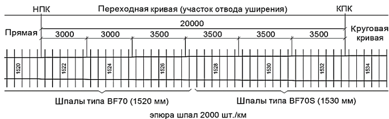
Рисунок 6. Схема отвода ширины колеи 1520 – 1534 мм на шпалах типа BF70 и BF70S в кривых радиусом 299 м и менее при длине переходных кривых (участок отвода уширения) 20 м
