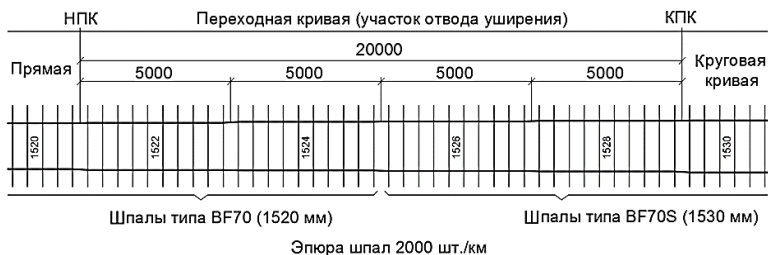
Рисунок 5. Схема отвода ширины колеи 1520 – 1530 мм на шпалах типа BF70 и BF70S в кривых радиусом от 349 до 300 м при длине переходных кривых 20 м
