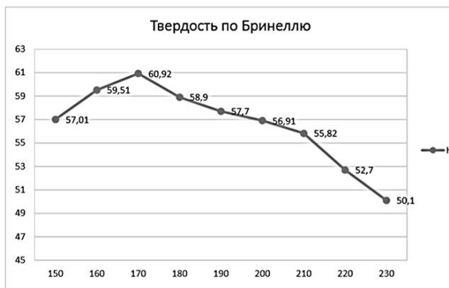
Рисунок 1. Значения твердости по Бринеллю сплава АК12 после искусственного старения при 150-230 °С и выдержке 4 часа
