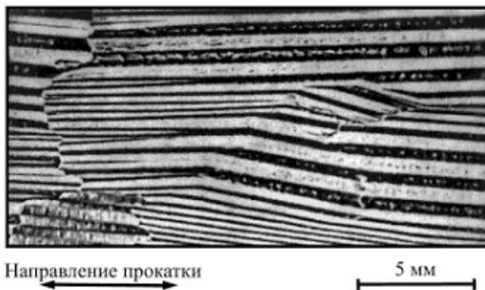
Рисунок 1. Доменная структура высокопроницаемой анизотропной электротехнической стали
