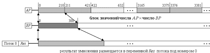
Рисунок 4. Выполнение умножения блока данных числа A на число B в потоке с номером 0
