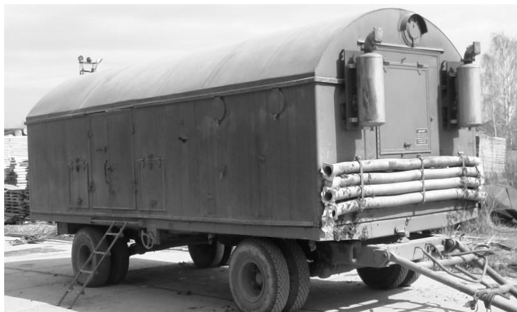
Рисунок 1. Передвижная дизель-электростанция 5И57А
