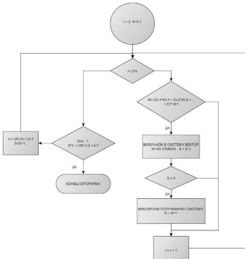
Рисунок 1. Алгоритм перебора всех возможных ЛНЗ систем векторов
