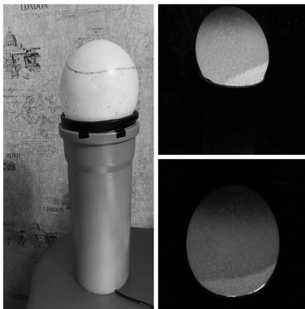
Рисунок 2. Процесс овоскопирования страусиного яйца
