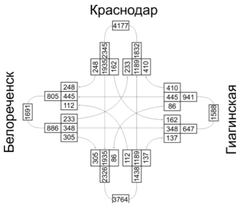
Рисунок 2. Интенсивность транспортных потоков на 31 км автомобильной дороги Майкоп-Усть-Лабинск-Кореновск
