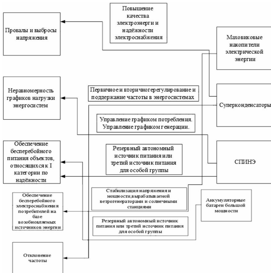
Рисунок 3. Систематизация соответствия типа накопителя электрической энергии решаемой проблеме для получения наибольших эффектов
