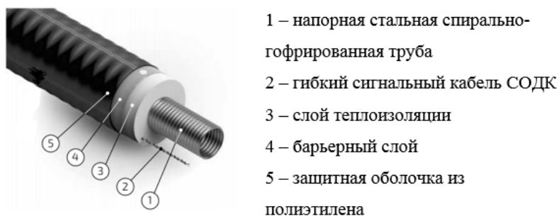
Рисунок 2. Конструкция гибких стальных теплоизолированных труб
