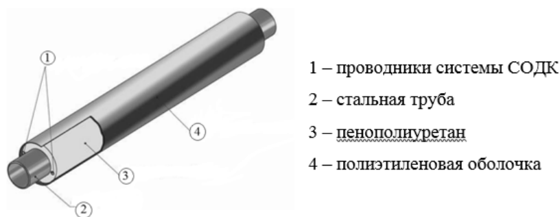
Рисунок 1. Конструкция стальных теплоизолированных труб с защитной оболочкой
