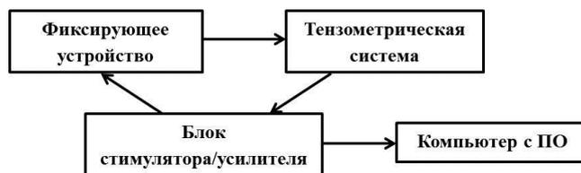
**Рисунок 3. Схема установки для оценки силы мышц при электростимуляции**
