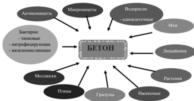
**Рисунок 1. Биологические разрушители бетона**
