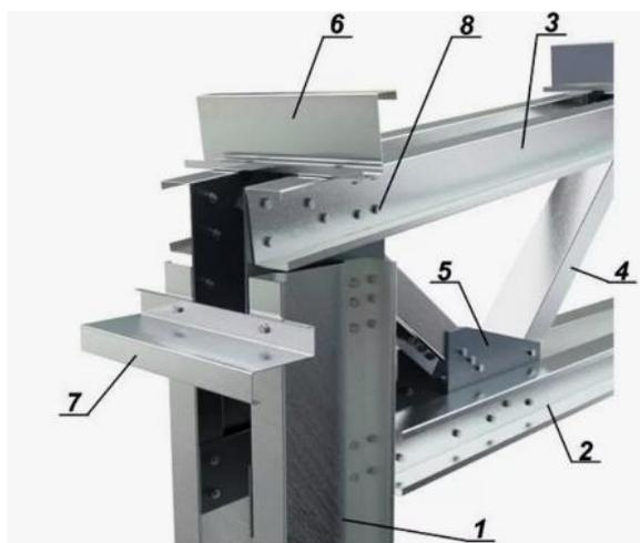
**Рисунок 3. Узел соединения фермы и колонны ЛСТК:** 1 – колонна металлического каркаса, 2 – нижний пояс стропильной фермы, 3 – верхний пояс стропильной фермы, 4 – раскос, 5 – узловая фасонка, 6 – Z-образный профиль (кровельный), 7 – Z-образный профиль (стеновой), 8 – болт (по расчету)
