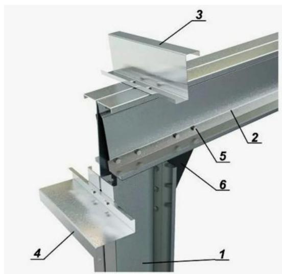
**Рисунок 4. Узлы соединения стропильной балки и колонн ЛСТК:** 1 – несущая колонна, 2 – стропильная балка, 3 – Z-образный профиль (кровельный), 4 – Z-образный профиль (стеновой), 5 – болт (по расчету), 6 – соединительная фасонка
