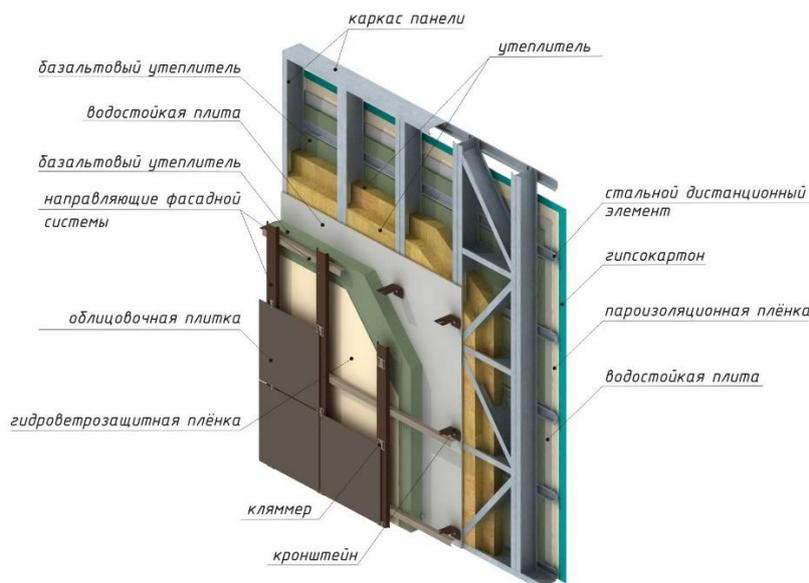
**Рисунок 1. Пример состава готовой ЛСТК панели**
