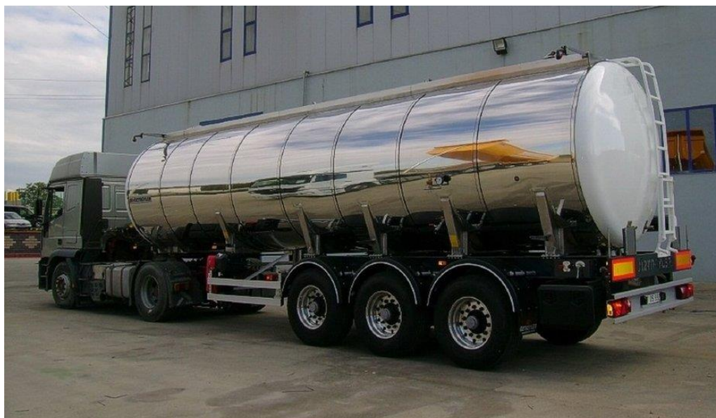
Рисунок 4. Современная цистерна из улучшенной стали AISI 304
