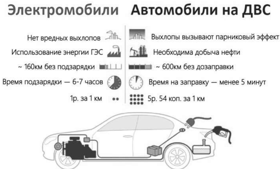
Рисунок 2. Сравнение критериев автомобиля с ДВС и электромобиля
