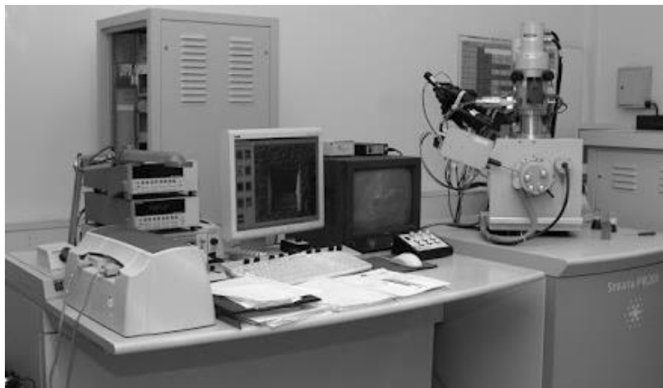
Рисунок 1. Сканирующий ионный микроскоп Strata FIB 205
