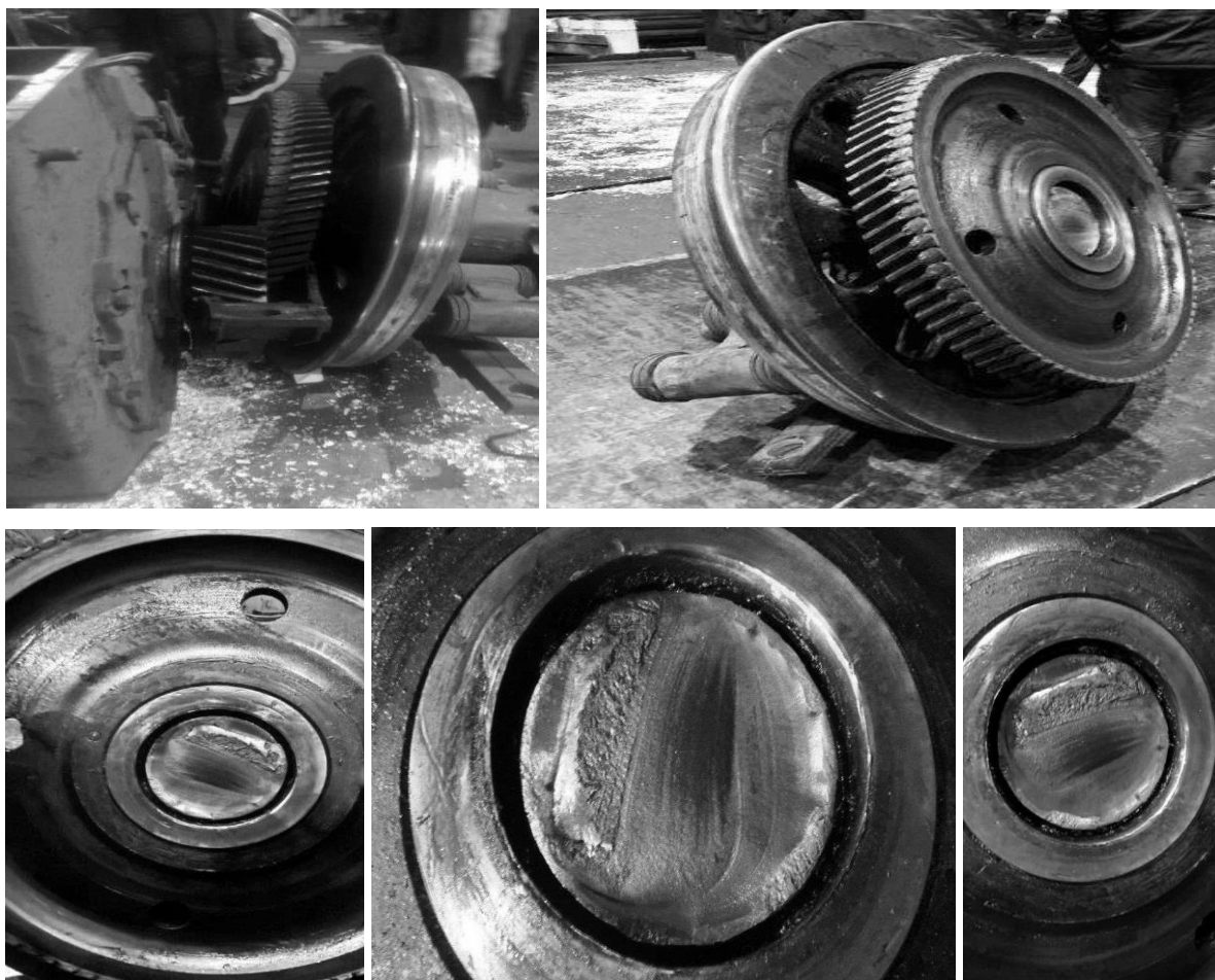
Рисунок 1. Фрагменты излома оси колесной пары № 6709
