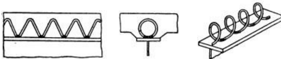
Рисунок 1. Соединение железобетона и стали система «Альфа»
