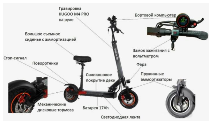
Рисунок 2. Строение электросамоката
