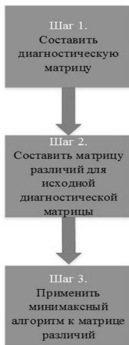
**Рисунок 1. Алгоритм по шагам метода редукции тестового набора**
