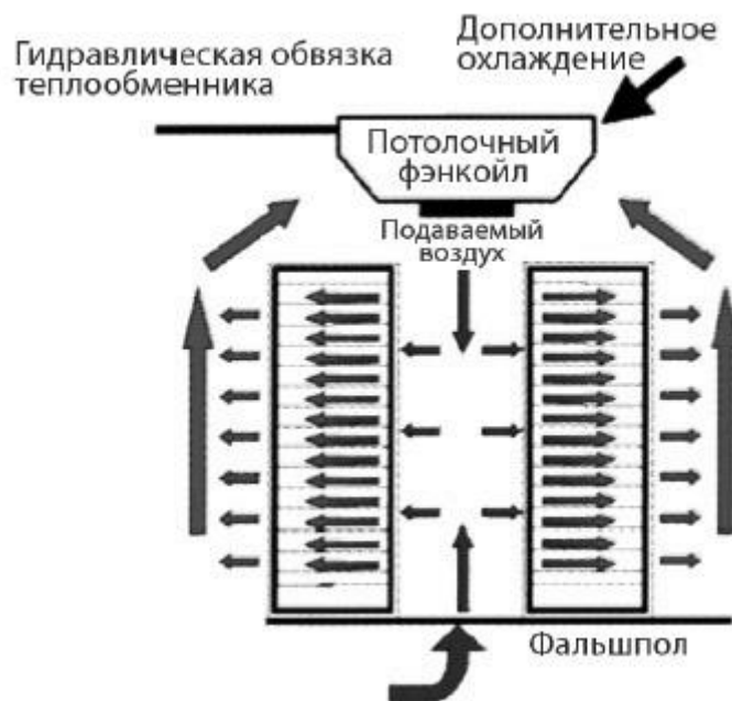
Рисунок 3. Схема приточного фэнкойла
