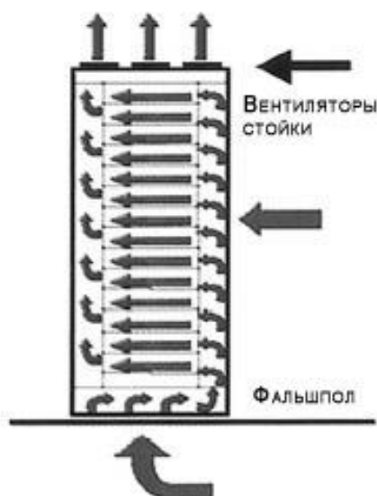
Рисунок 2. Схема вентилируемой стойки
