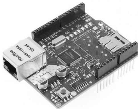
**Рисунок 3. Плата расширения Arduino Ethernet**
