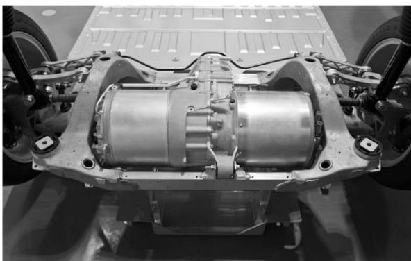
**Рисунок 2. Расположение электродвигателя на оси электромобиля Tesla**
