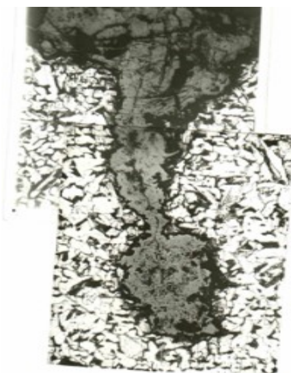
Рисунок 3. Характер трещин, развивающихся с внутренней поверхности нейтральной зоныгиба
