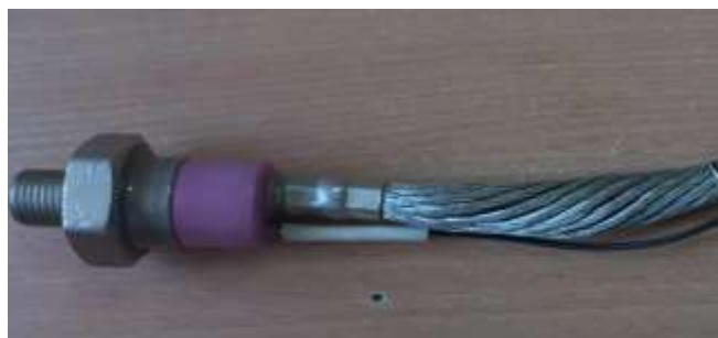
Рисунок 1. Внешнее строение туннельного диода
