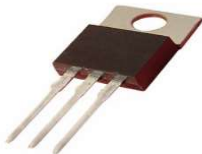
Рисунок 1. Внешнее строение полевого транзистора
