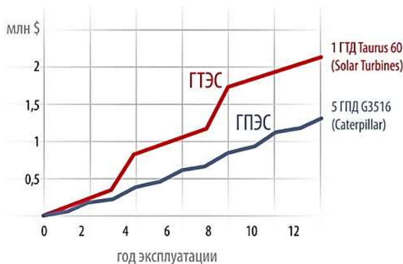
Рисунок 2. Эксплуатационные затраты на электростанцию мощностью 5 МВт
