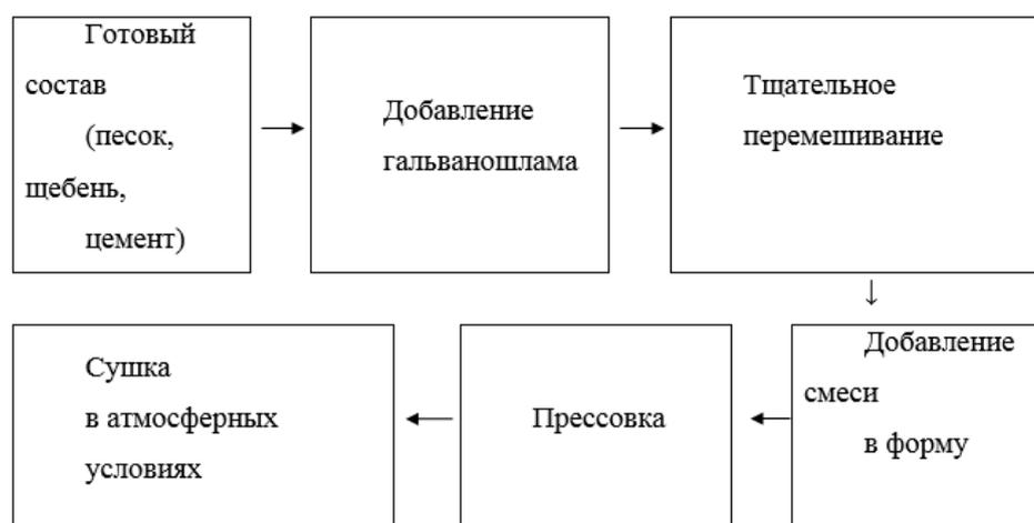
**Рисунок 1. Технологическая схема производства тротуарной плитки с добавлением гальваношлама**
