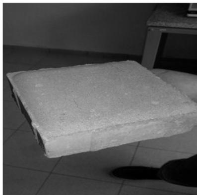
**Рисунок 2. Полученная плитка с добавлением гальваношлама**
