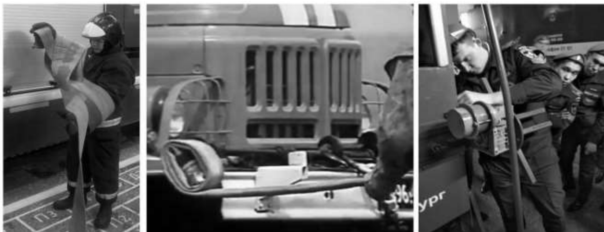
Рисунок 1. Скатка (смотка) рукавов: а – ручным способом; б – с помощью рукавного автомобиля АР-2 (ЗИЛ-131); в – с помощью рукавного автомобиля АР-2 (КАМАЗ-43318)
