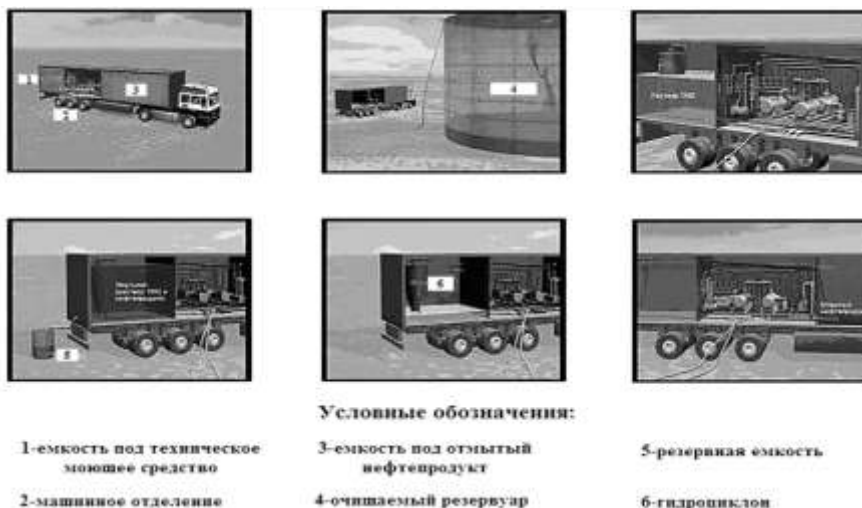
Рисунок 1. Схема устройства мобильного комплекса безотходной зачистки резервуаров
