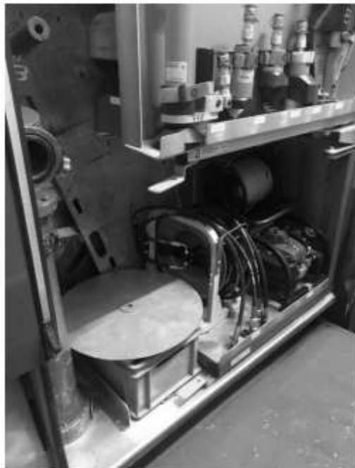
Рисунок 3. Один из вариантов размещения предлагаемого технического решения на примере АЦ-3,2-40/4 (КАМАЗ 43253)
