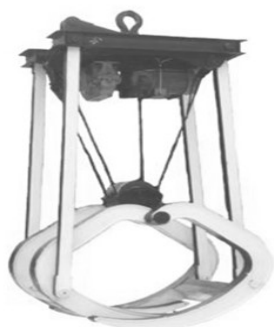
Рисунок 4. Грузозахватные устройства для перегрузки круглого леса
