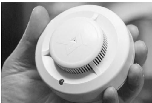
**Рисунок 1. Автономный дымовой пожарный извещатель**
