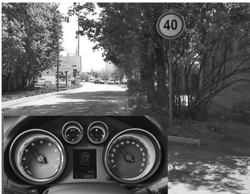
Рисунок 5. Пример работы системы «Opel Eye» при повернутом дорожном знаке в 40-45 градусов
