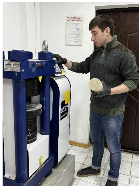
Рисунок 9. Гидравлический пресс MATEST C055 на 2000 кН
