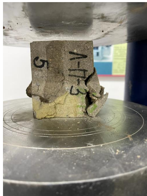
Рисунок 11. Испытания образцов песка. В момент испытания и после испытания их на сжатие
