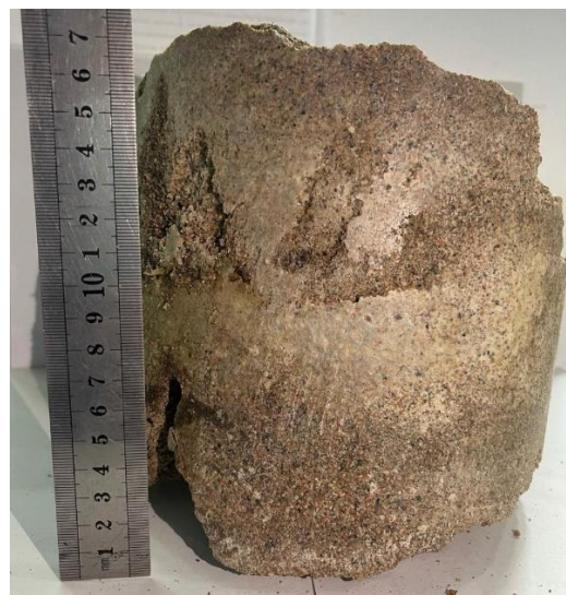
Рисунок 7. Пример закрепления песка двухкомпонентной смолой в лабораторных условиях
