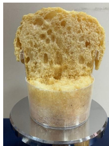
Рисунок 3. Закрепление смолы в различных вариантах совмещение компонентов А и Б
